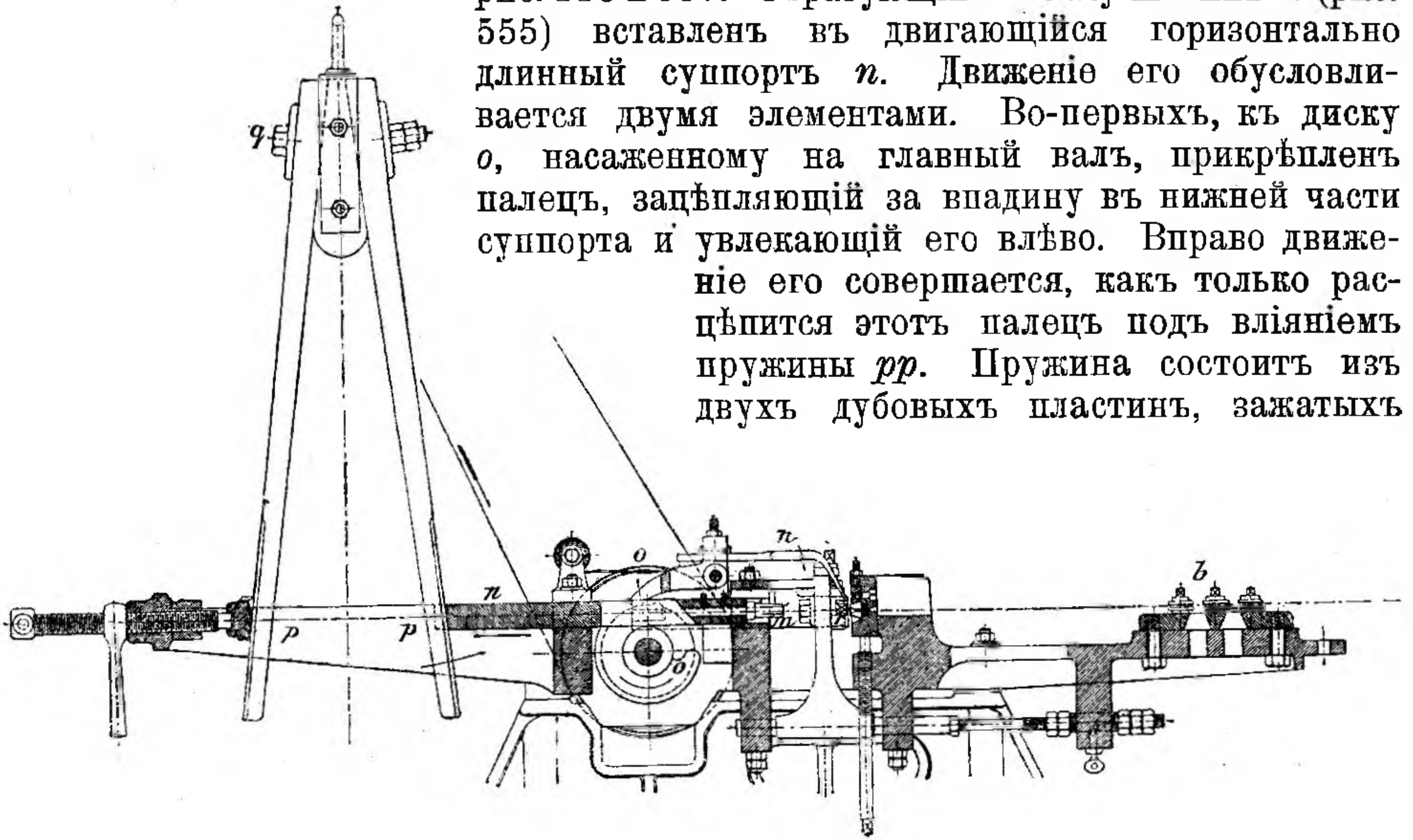
555. Машина для изготовленія проволочныхъ гвоздей Malmedie & Co, разрѣзъ.
